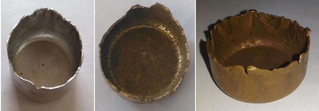
**FIG-12: DRAWN CUP FROM THE AL 1100, COPPER AND BRASS**
